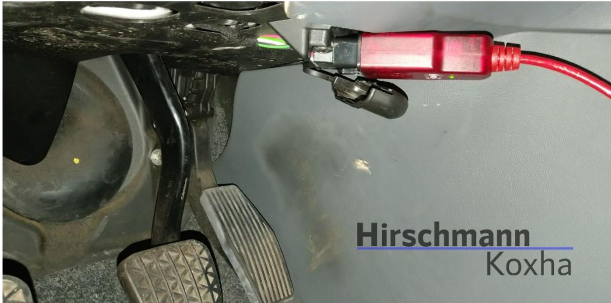
Drehen Sie nun den Zündschlüssel in die Stellung „**ON**“ und schalten Sie alle Verbraucher wie z.B. Radio, Scheinwerfer, Sitzheizung, Klima, usw. aus. Stecken Sie das Kabel nun in Ihren Laptop und öffnen Sie den „*TrionicCANFlasher*“.
